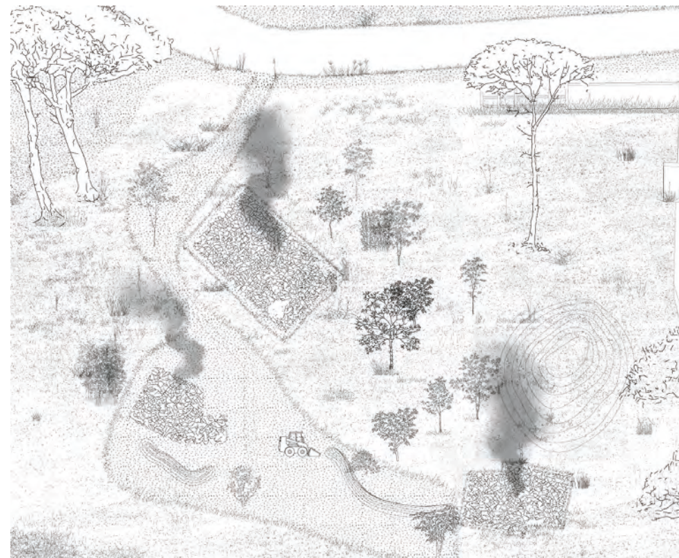
Borgo di Santo Pietro, Caltagirone, Aprile 2024. Elaborazione grafica di C. Feminò e C. Foti. Avvio dei primi movimenti di terra per la preparazione del suolo. Dalla convergenza di contributi eterogenei viene definito il posizionamento delle strutture trasferite da Venezia e tracciato l'impianto delle fondazioni. Con l'ausilio di un archipendolo si individuano i salti di quota, sui quali vengono modellati gli swales (fosse livellari), in una prospettiva di retro-innovazione.
