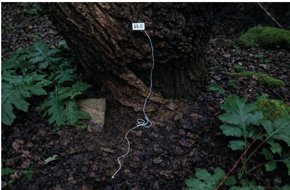
Sperimentazione in situ presso la Fontana del Cacciatore, Bosco di Santo Pietro. Posizionamento di sensori di monitoraggio (temperatura e umidità del suolo) in prossimità di una quercia secolare per la definizione dei parametri ambientali del Terrarium. Fotografia di Feminò C.
