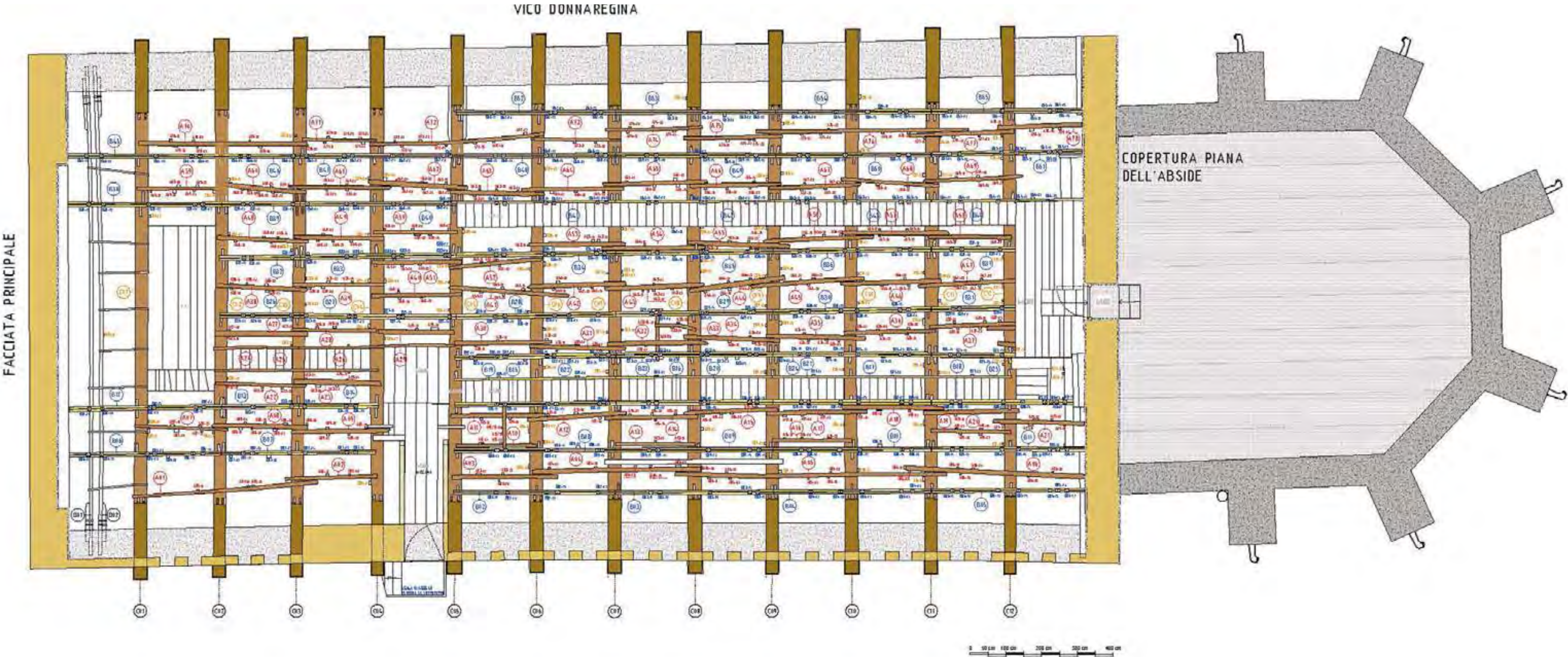
26. Pianta del sottotetto della chiesa di s. Maria di Donnaregina con indicazione delle dodici capriate e dell'intricato sistema di elementi lignei che sostiene il cassettonato
