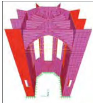
71. Mappa tensionale dello sforzo normale in direzione verticale del modello di calcolo
