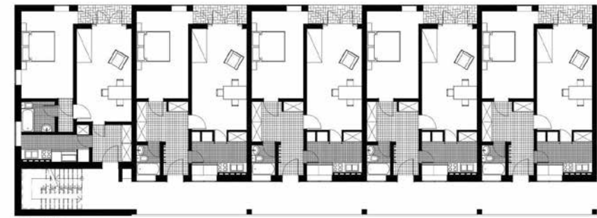
Alloggi dell'edificio a ballatoio in Rione Luzzatti / 'Gallery access' apartments in Luzzatti Block.
