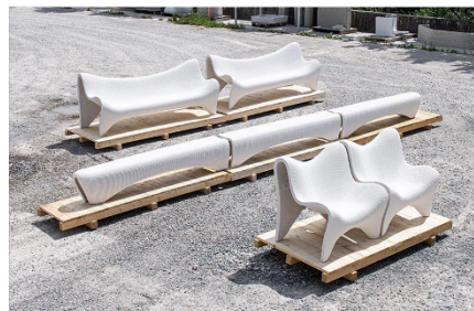
(Fig. 12) Scenario di reimpiego dei materiali da demolizione attraverso processi stampa 3D: ipotesi di cantierizzazione, contenuto materico del materiale per la stampa e campionario di possibili prodotti. Courtesy of Flavio Galdi
