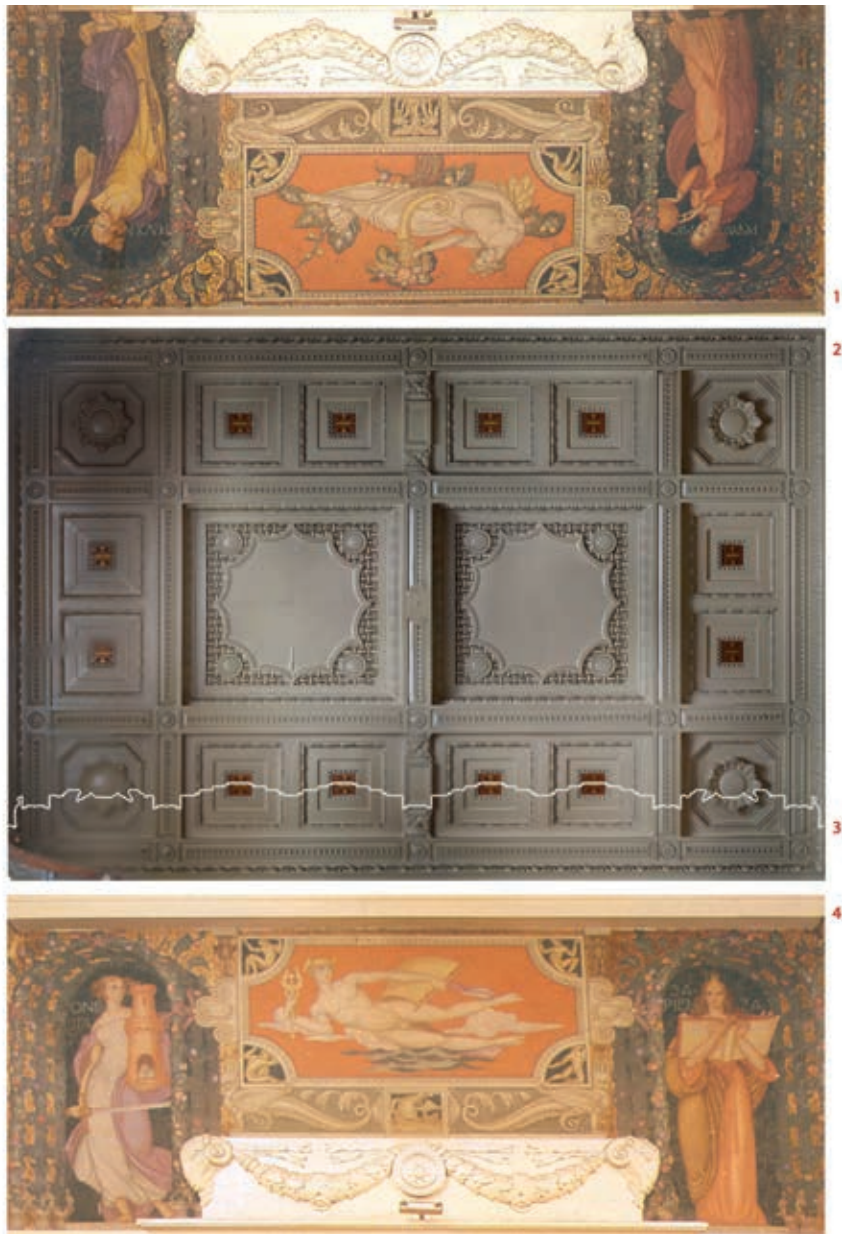
Figura 4: Vestibolo d'ingresso (da via Verdi). Integrazione dei dati: ortoproiezione ipografica del soffitto da nuvola di punti image based (2) con profilo vettorializzato (3) del cassettonato decorativo da nuvola di punti range based ; gli affreschi esistenti sulle pareti verticali sono rappresentati mediante il fotoradrizzamento di fotografie (1 e 4).
