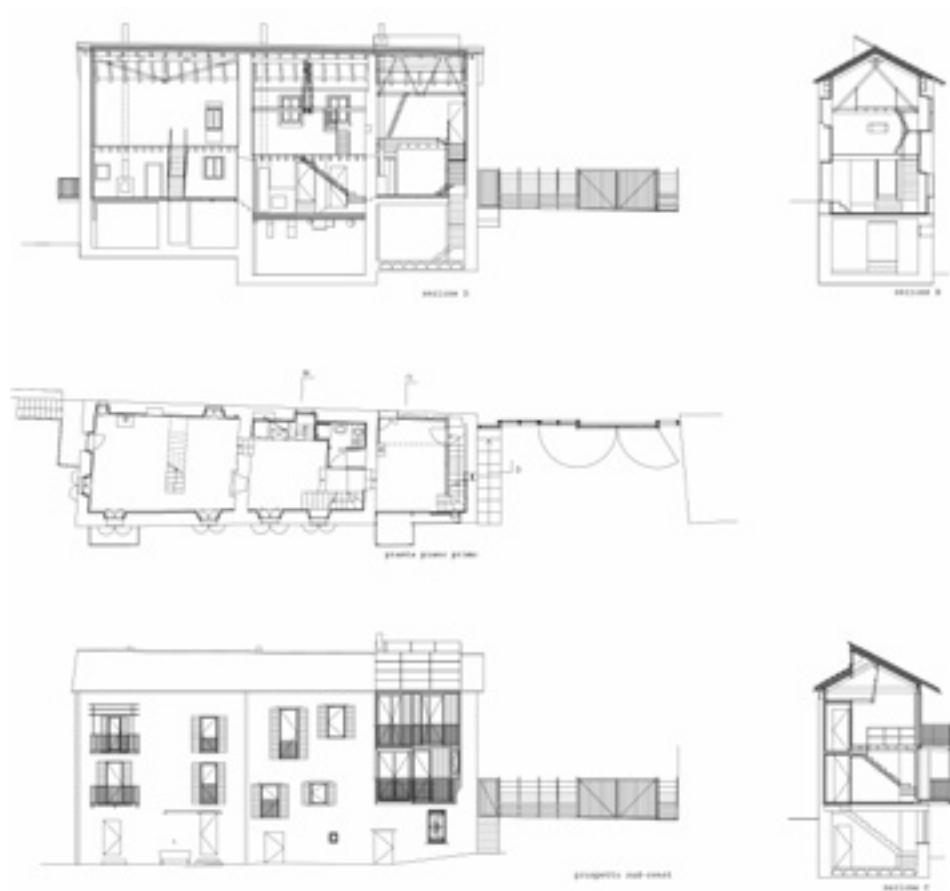
Sopra: pianta primo piano, sezioni e prospetto sud-ovest del corpo di fabbrica principale Pagina a fianco: fasi di autocostruzione in cantiere. Foto di studio Albori
