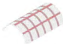
A.3 Presidio di collegamento strutturale tra le parti esistenti e le nuove sezioni in laterizio della volta con fasce di fibre in acciaio galvanizzato e malta traspirante a base di pura calce idraulica naturale. Riempiimento dell'estradosso della volta con malta a base di calce e argilla espansa.
