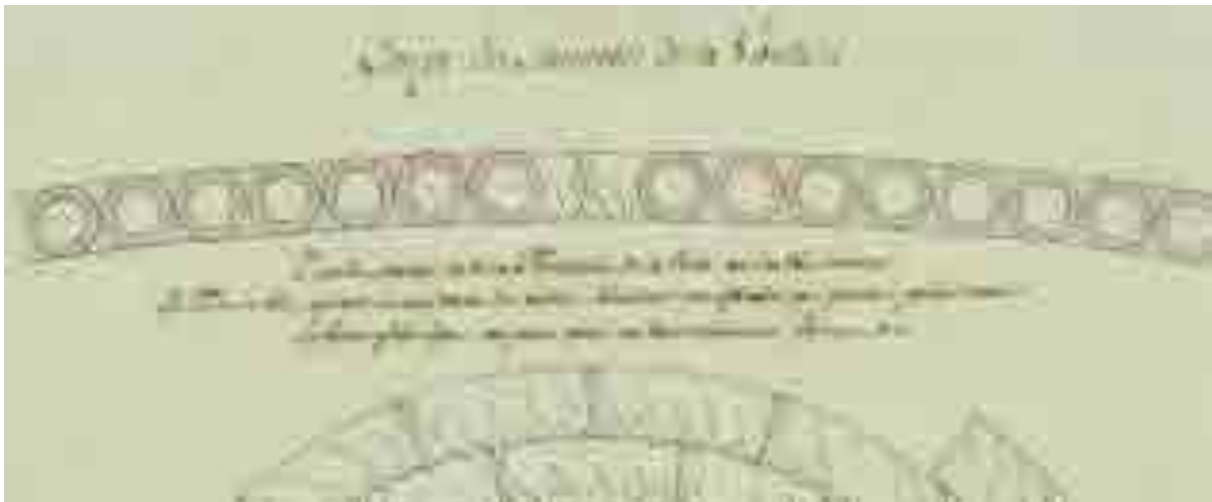
P.-A. Pâris, Ravenna, Chiesa di San Vitale. Dettaglio del sistema costruttivo della cupola. (Besançon, Bibliothèque Municipale, Fonds Pâris, vol. 479, n.4)
