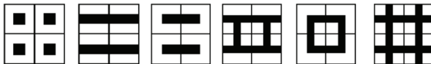
Figura 3. Le “ generic urban forms ”, basate sugli archetipi di Martin and March e rianalizzate in termini ambientali da Steemers et al. . Da destra a sinistra: pavilions , slabs , terraces , terrace-courts , pavilion-courts and courts . Fonte: elaborazione degli autori sulla base di C. Ratti et al. 2003.
