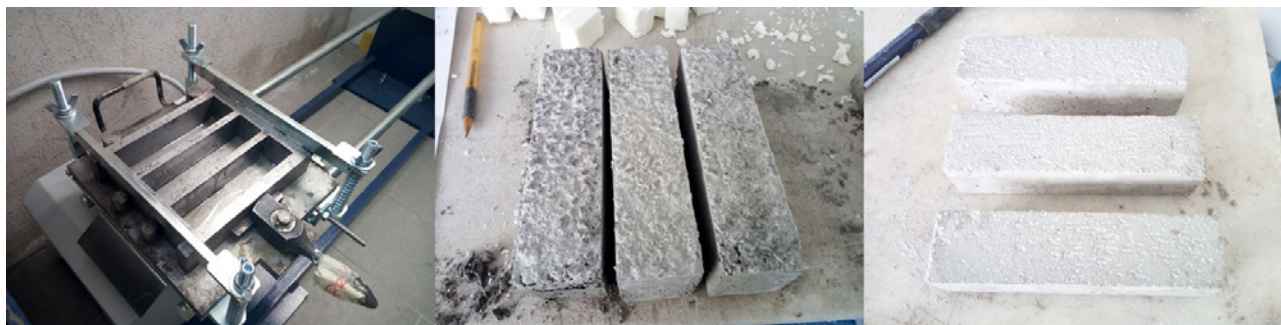
Fig. 1. Confezionamento dei provini. Da sinistra verso destra: stampi prismatici di acciaio; campioni della miscela 2C; campioni della miscela 5HL.
