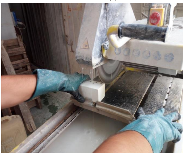
Figura 11 - Taglio dei provini con sega circolare
