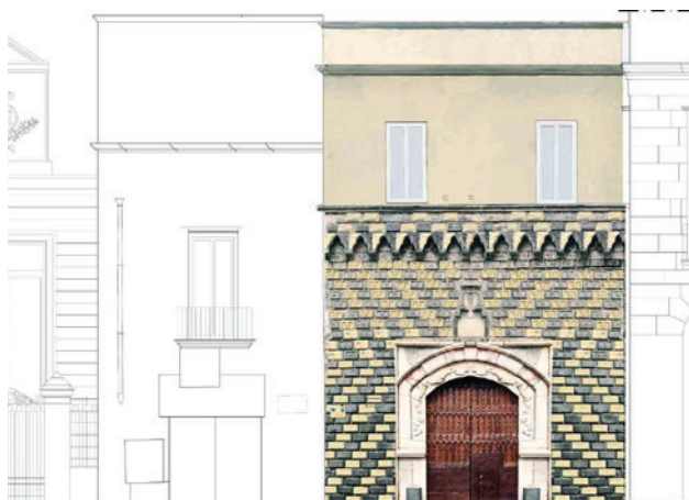
Fig. 9. Palazzo Penne. Progetto di conservazione delle superfici. Prospetto su piazzetta Teodoro Monticelli con la simulazione dei risultati attesi.
