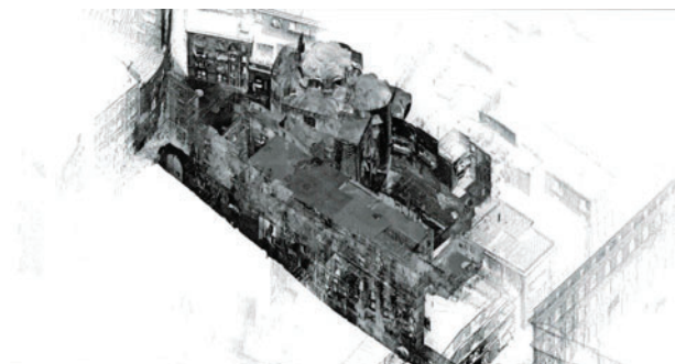
Fig. 8. Palazzo Penne. Rilievo laser scanner e nuvola di punti.
