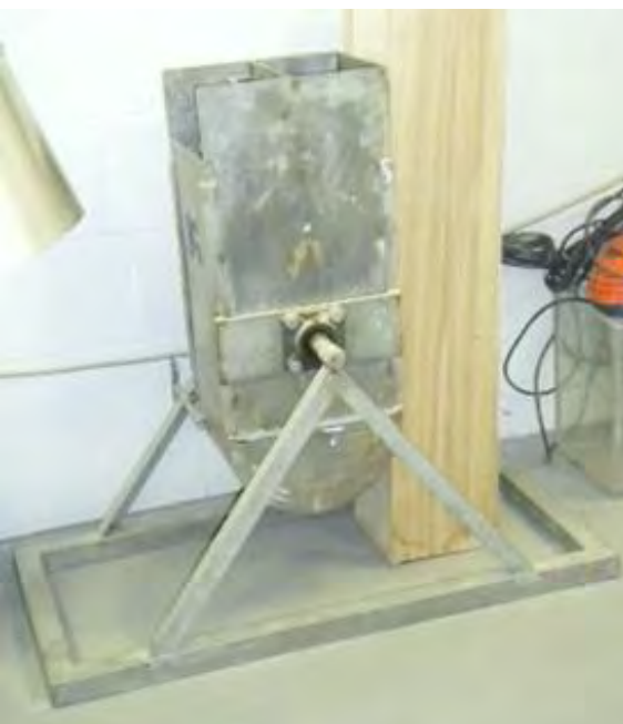
Figg. 97 e 98 Prova di svuotamento della scatola a U / U box Test
