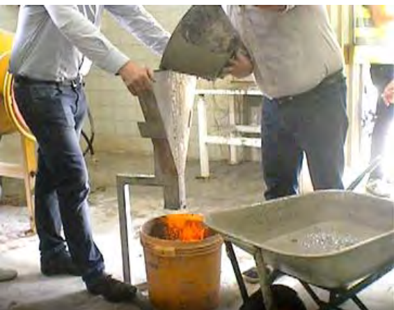
Fig. 94 V Funnel Test di una miscela di SCC nel laboratorio della Calcestruzzi di Casalnuovo (NA) / V Funnel Test of SCC mixture in the laboratory of "Calcestruzzi" in Casalnuovo (NA)
