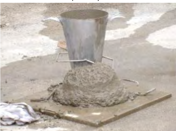
Fig. 85 Spandimento al cono di Abrams per la valutazione dell'autocompattabilità / Spreading to the cone of Abrams for the evaluation of the auto-compactability
