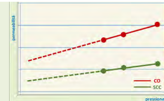
Fig. 124 Confronto della permeabilità tra un SCC e un CO / Comparison of the permeability between an SCC and a CO
