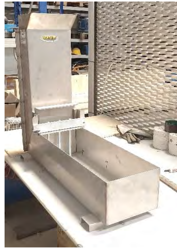
Figg. 95 e 96 Prova di svuotamento della scatola a L / L box Test
