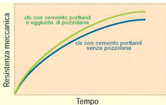
Fig. 51 Resistenza meccanica nei conglomerati con o senza pozzolana / Mechanical resistance in conglomerates with or without pozzolana
