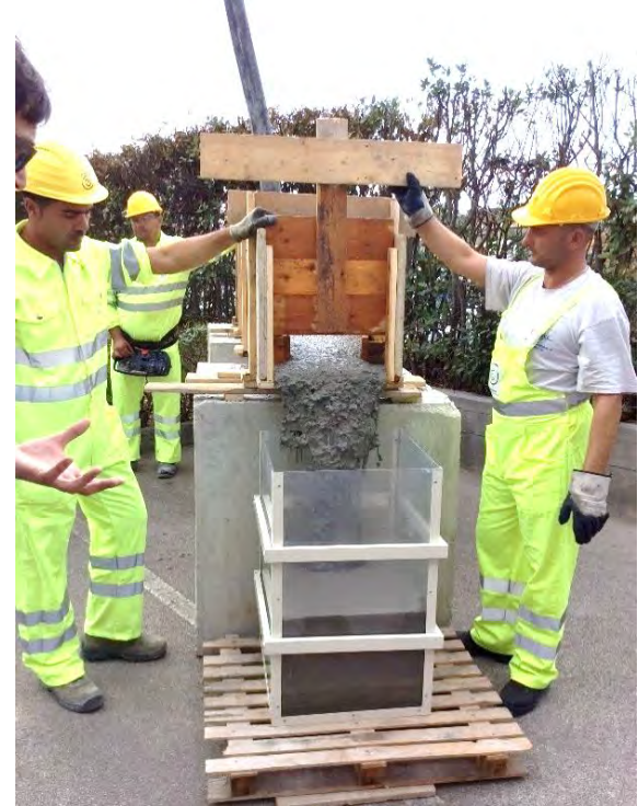
Fig. 5 Dimostrazione delle proprietà reologiche del calcestruzzo autocompattante presso la Calcestruzzi di Casalnuovo (NA) / Dimostration of a self compacting concrete rheological proprieties, made at the Calcestruzzi of Casalnuovo (NA)
