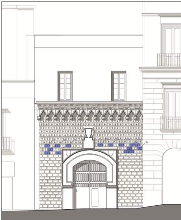
Fig. 7 Informazioni associate al modello BIM: prospetto principale con abaco delle bugne
