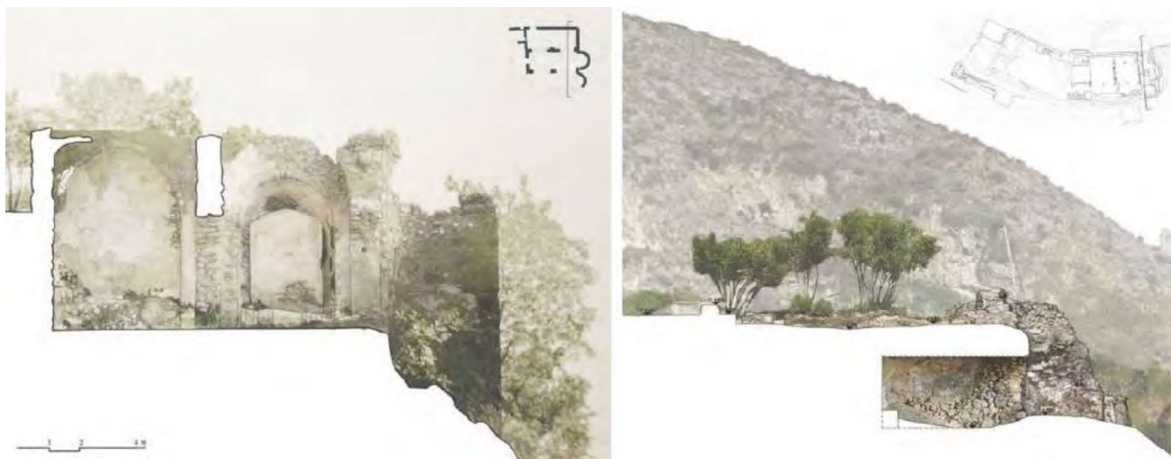
3: A sinistra, Agerola, chiesa di Santa Barbara, sezione rivolta verso l'area absidale (rielab. dell'autrice da un rilievo di C. Langella). A destra, Crapolla (Massa Lubrense), abbazia di San Pietro, sezione rivolta verso l'area absidale (elab. dell'autrice).
