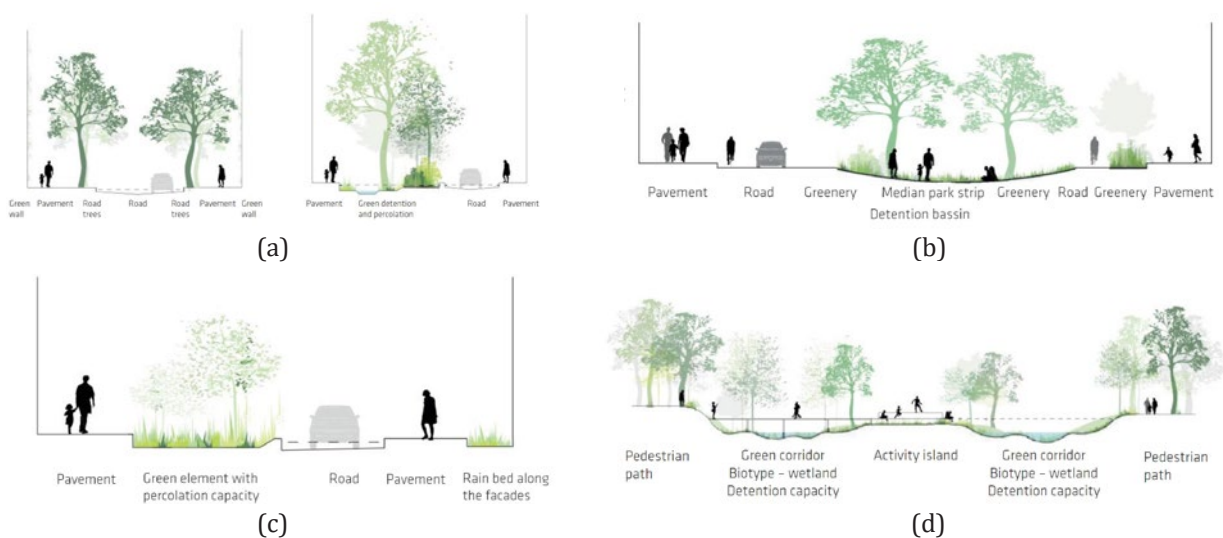
Figure 4: Sezioni stradali tipologiche di soluzioni Cloudburst per la città di Copenhagen: stormwater roads (a); detention roads (b); detention areas (c); green roads (d). SLA Landskabsarkitekter. Fonte: The Municipality of Copenhagen
