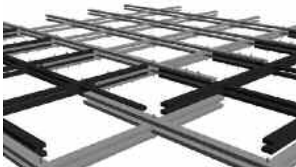
3. La sovrapposizione tra le aste per la giunzione bullonata dei moduli
