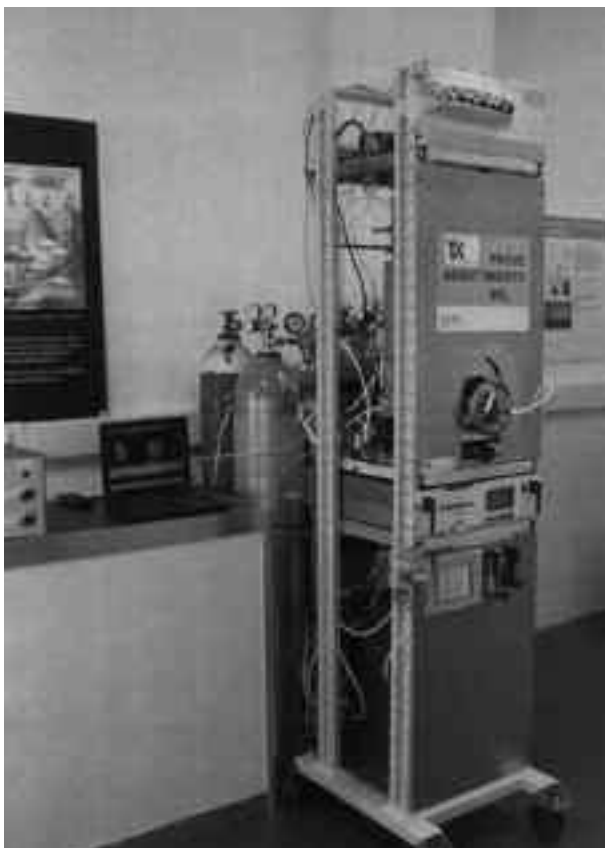
3. CTG, strumentazione per la prova di abbattimento NOx
