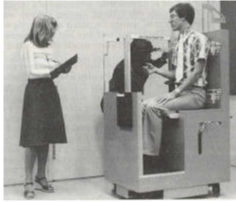
Fig. 2.2. - Misuratore antropometrico della General Motors.
