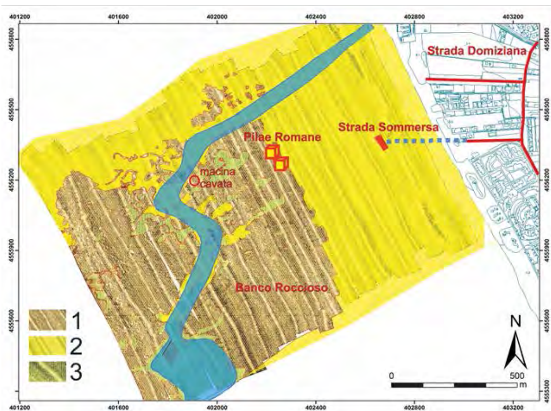
Fig. 8.1 - Schema della morfologia del fondo marino acquisita con rilievi Side-scan Sonar: 1) fondo marino caratterizzato da sedimentazione sabbiosa; 2) paleoalveo; 3) banco roccioso di natura ignimbratica, intensamente fratturato ed inciso dal paleoalveo
