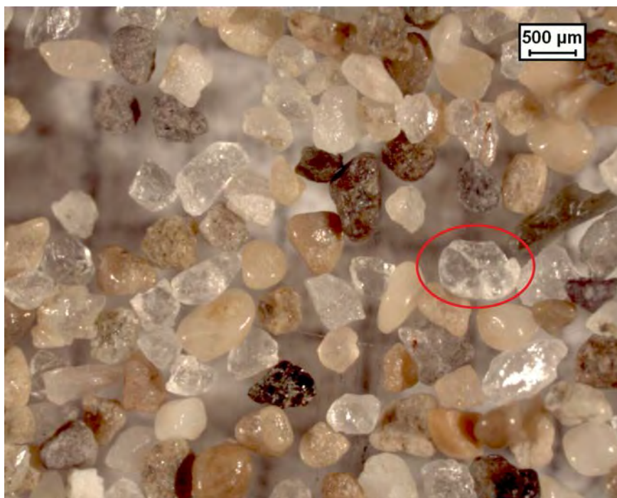
Fig. 7.5 - Osservazione al microscopio della frazione granulometrica pari a 500 \mu , separata dal campione S2 prelevato sulla battigia lungo la spiaggia emersa. Esempio di granulo di quarzo (evidenziato con l'ellisse rossa) definito come smussato trasparente
