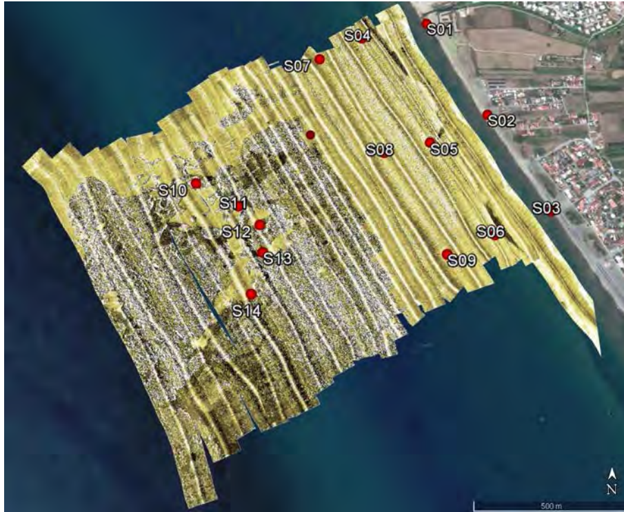
Fig. 7.1 - Frazione di fondale marino-costiero, prospiciente l'area costiera occupata dall'antica colonia romana di Sinuessa, rilevata con Side-scan Sonar L3 KLEIN Associates, mod. 3900, operante con frequenza acustica ad alta risoluzione (450 kHz) e con range di 30 m per canale. L'area rilevata ha forma rettangolare con lato 1,5 km x 1,2 km ed è posizionata a circa 60 m dalla linea di riva in direzione NNO-SSE, con un overlap dei dati acquisiti pari al 30% per ciascuna fascia rilevata (24 in totale). Sono riportate altresì le ubicazioni dei punti di prelievo dei campioni di fondo marino mobile acquisiti nell'ambito della presente ricerca
