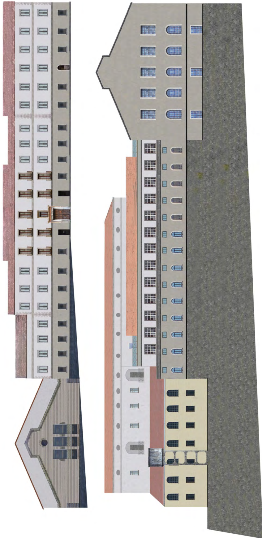
(pag. precedente) 6-7-8. Rilievo del degrado della facciata nord con il particolare del capannone orientale da quel lato (sopra) e i relativi interventi di conservazione della materia (sotto). Più in basso, planimetrie di progetto con organigrammi delle nuove destinazioni d'uso. 9. I fronti nord e sud restaurati.
