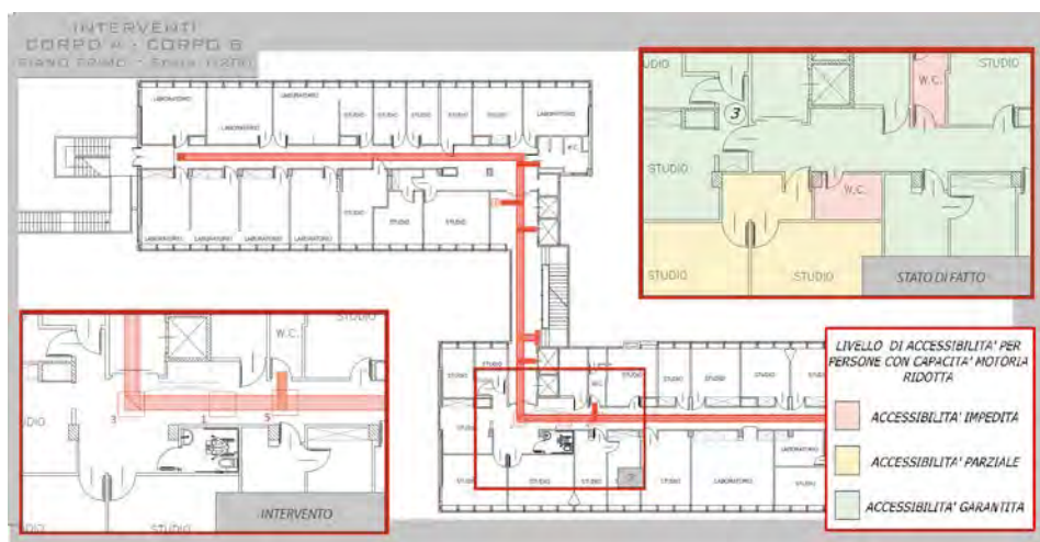
4. Intervento negli spazi interni: installazione di percorsi tattili e revisione dei servizi igienici.
