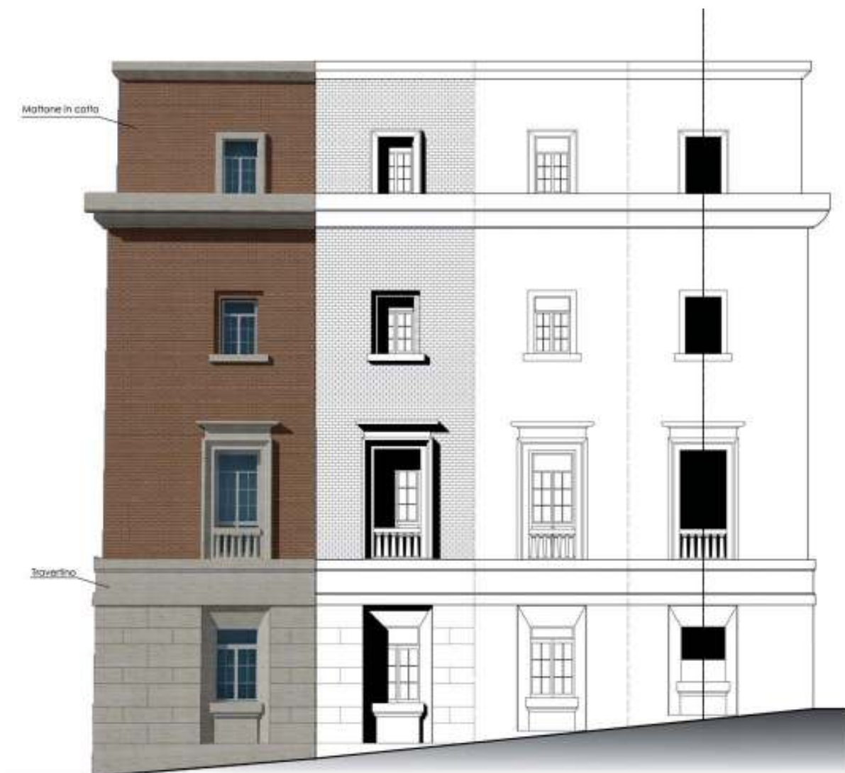
Centro Congressi. Analisi del prospetto laterale con quattro gradi di lettura. Da sinistra: vista renderizzata con i materiali; definizione della volumetria attraverso l'applicazione delle ombre; disegno degli elementi di facciata; analisi del rapporto vuoti/pieni.
