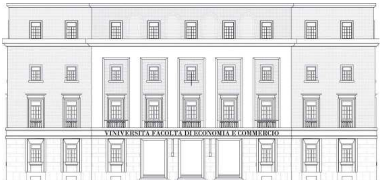
Il prospetto del Centro Congressi. In alto l'eidotipo con l'analisi proporzionale, in basso la restituzione grafica.
