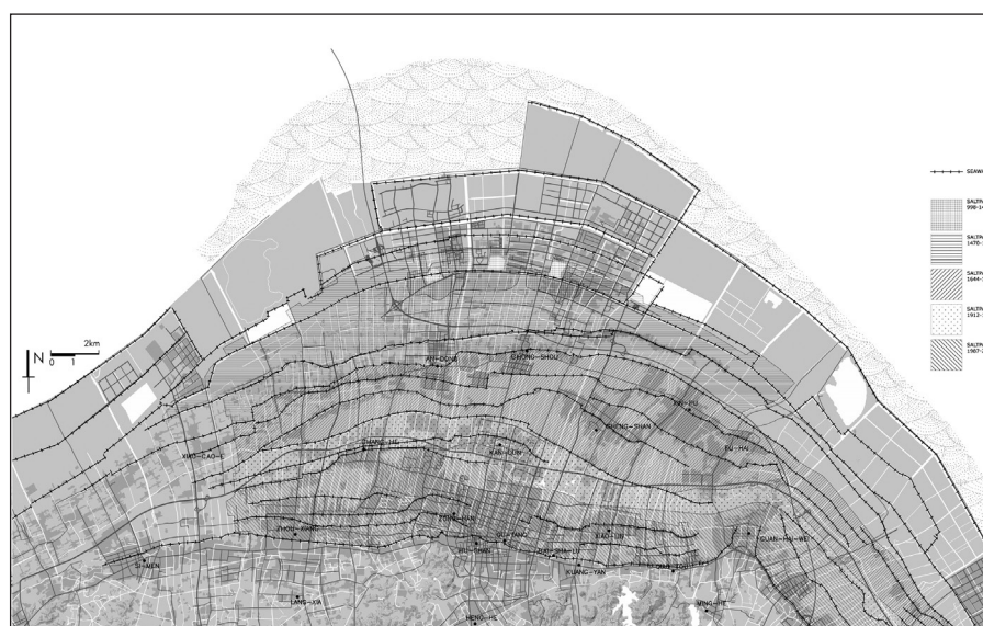
Fig. 4 - Tracciati degli argini ( sea walls ) dei polder nel distretto di Cixi
