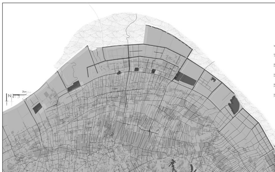
Fig. 5 - Rete dei canali paralleli – tang – e perpendicolari – pu – alla linea di costa dei polder nel distretto di Cixi
