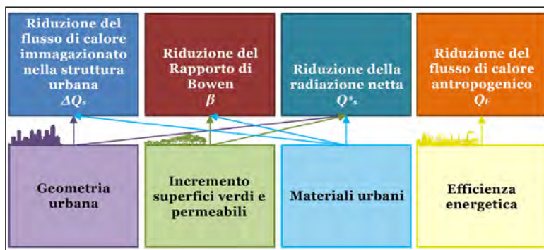
Fig. 17 Principali strategie di mitigazione dell'UHI e relativa influenza sui termini del bilancio di energia della superficie.
