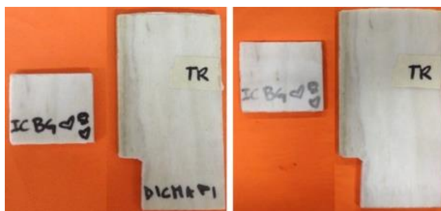
Figura 8 - Campioni di marmo tal quale e trattati con SurfaPore poi ripuliti.
