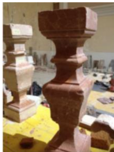
Figura 12 - Valutazione grado di pulitura della Colonnina in marmo oggetto di studio
