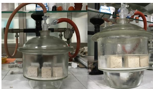
Figura 6 - Determinazione della porosità apparente e densità di Bulk
