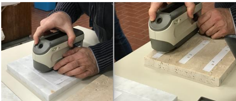
Figura 7 - Misurazioni effettuate con spettrofotometro sui vari campioni
