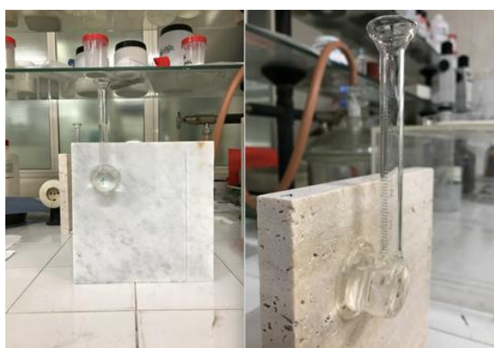
Figura 5 - La prova per la determinazione dell'assorbimento d'acqua a bassa pressione.
