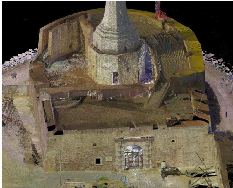
Fig. 5. Proiezione della nuvola di punti in RGB del Forte Campana. Si noti il portale di accesso al forte e base della stele votiva fondata sulla Torre di Sant'Anna.
