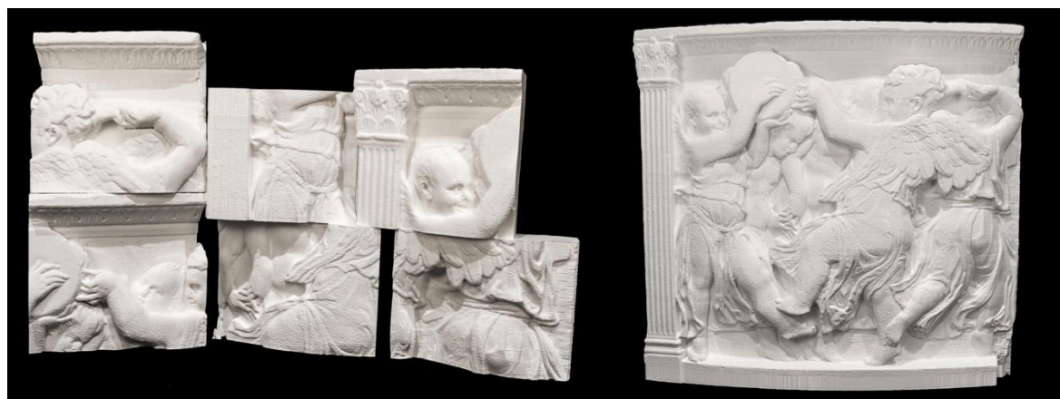
Figura 7. Le differenti porzioni in cui è stata suddivisa ciascuna delle due formelle III e IV per la prototipazione 3D in scala 1:1. A destra, una delle formelle a seguito del processo di assemblaggio e pulitura.
