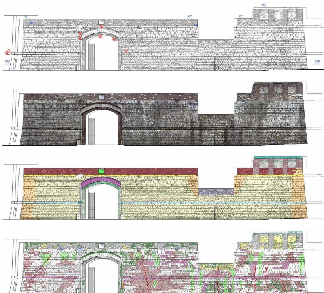
Figura 6. Bastione Stampace, estratto dalle analisi tematiche. Rappresentazione bidimensionale del fronte ovest: rilievo a fil di ferro, ortofoto, particolare analisi materico-strutturale e analisi del degrado.
