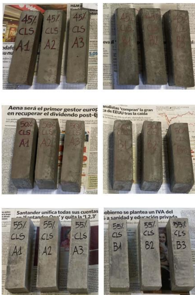
Figura 1. Provini realizzati con sostituzione di AR in percentuali di 45%, 50% e 55%.
