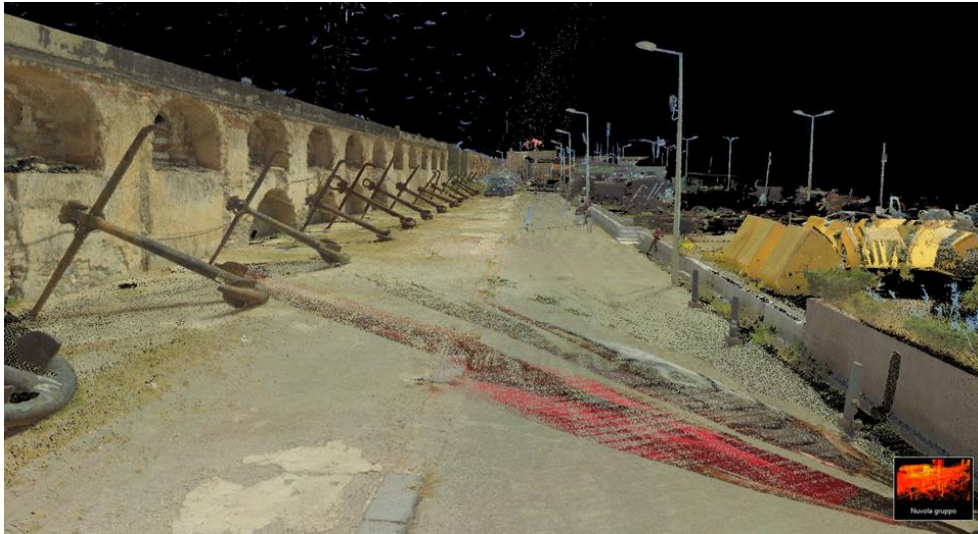
Fig. 8. Nuvola di punti delle bocche dell'interno del Forte del SS. Salvatore.
