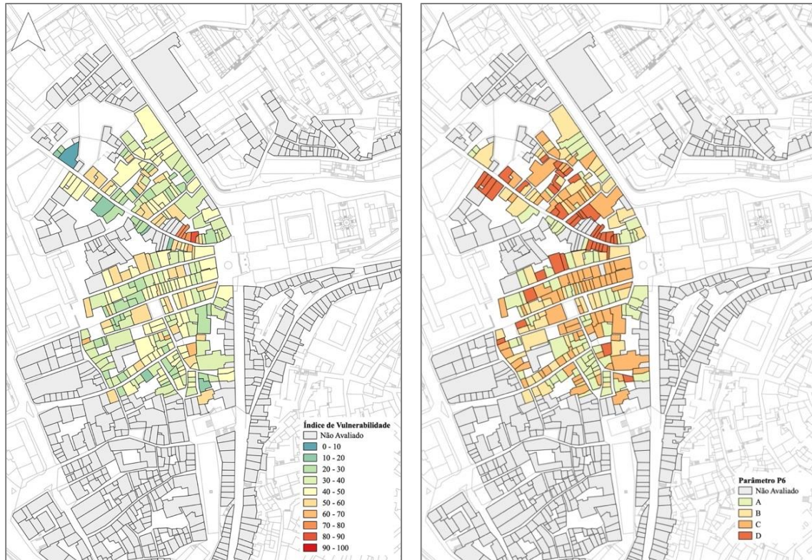
Figura 2. Mapeamento da vulnerabilidade sísmica dos edifícios avaliados (a) classes de vulnerabilidade obtidas; (b) parâmetro P6.
