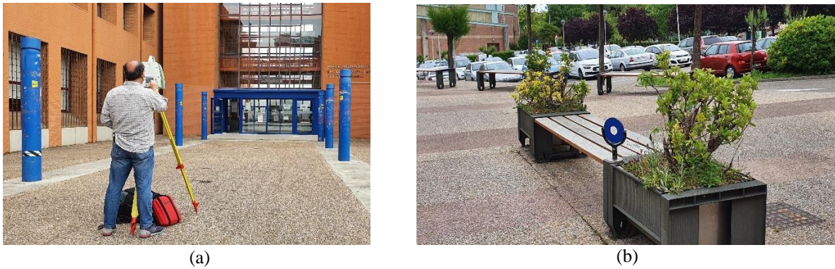
Figura 4. (a) Configuración de la toma con el equipo Leica Geosystem C10. (b) Dianas de enlace y referencia de los escaneados láser.
